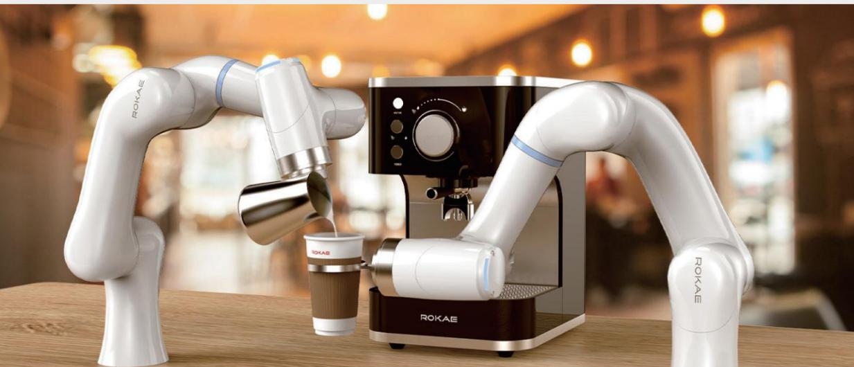
xMate SR-C系列柔性协作机器人在延续了xMate SR柔性协作机器人的特色和核心优势的基础上，将底座内的控制器移出本体形成独立控制柜，可应对更狭小的底座安装环境。同时xMate SR-C全面升级了5KG负载能力的产品。
