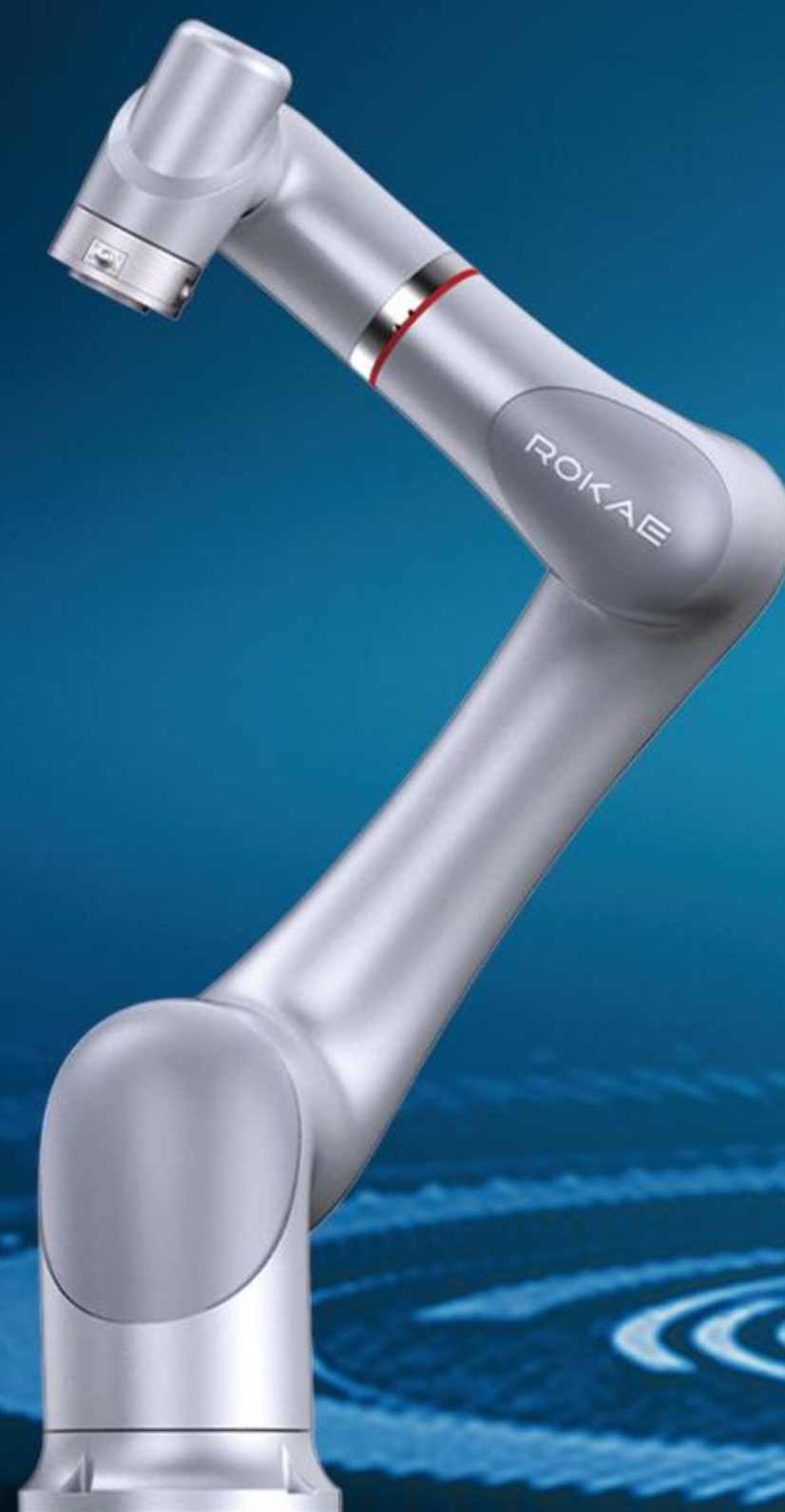
型号 CR18-C 负载 18kg 工作半径 1062mm
