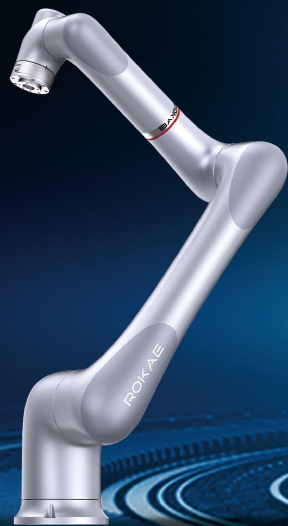
型号 CR12-C 负载 12kg 工作半径 1434mm
