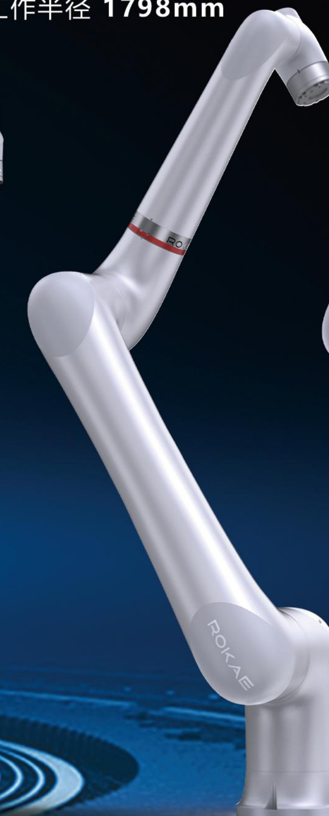
型号 CR25/5-C 负载 25kg 工作半径 1798mm
