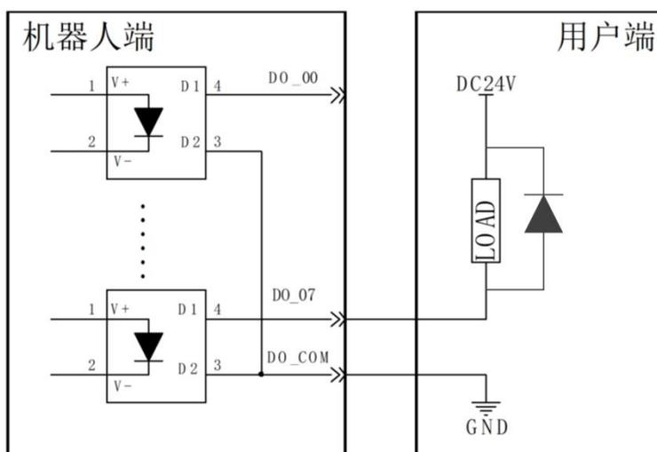
输出高电平有效，将 DO\_COM（公共端）连接到 24VDC，参考下图。
