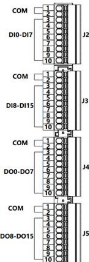
控制柜标配 16 路通用数字输入和 16 路通用数字输出，引脚定义如下：
