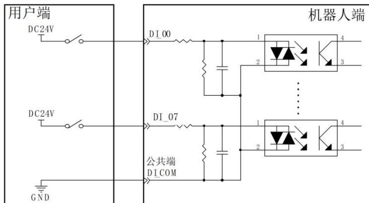
公共端接 24VDC, 接 NPN 输入信号, 可参考下图。
