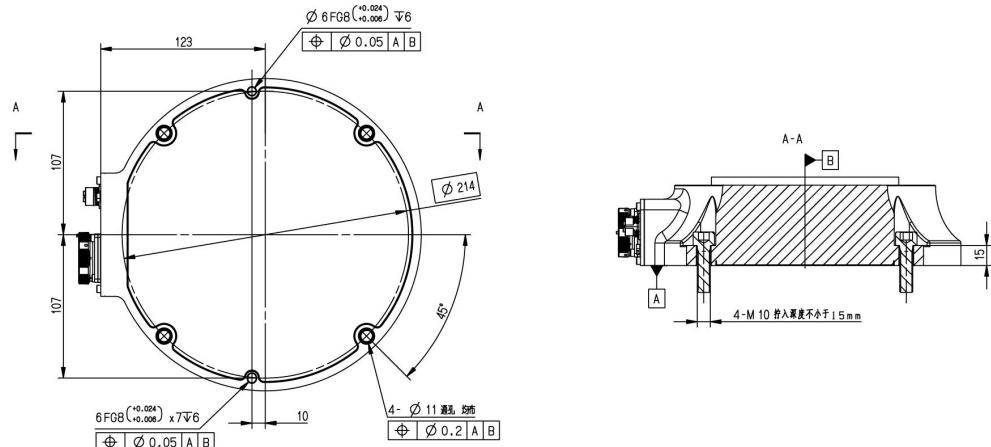
为保证定位准确可在预留的圆柱销孔中使用销钉定位，随后用 4 个 M10X35 的内六角圆柱头螺栓（强度等级 12.9 级）将机器人底座固定在支架上。
