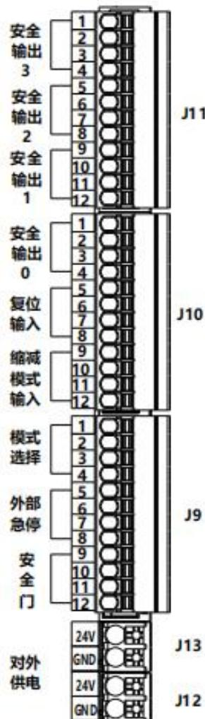
每一组安全输入或安全输出信号均为双路冗余，因此每一组安全信号均包含“回路 1”和“回路 2”两组 IO 点，共 4 个接线端子。引脚定义如下：
