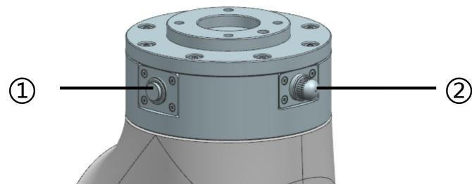
按住拖动示教按钮，可以使机器人进入拖动示教模式。
