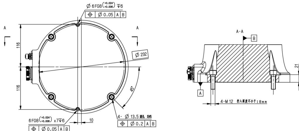
为保证定位准确可在预留的圆柱销孔中使用销钉定位，随后用 4 个 M12X40 的内六角圆柱头螺栓（强度等级 12.9 级）将机器人底座固定在支架上。
