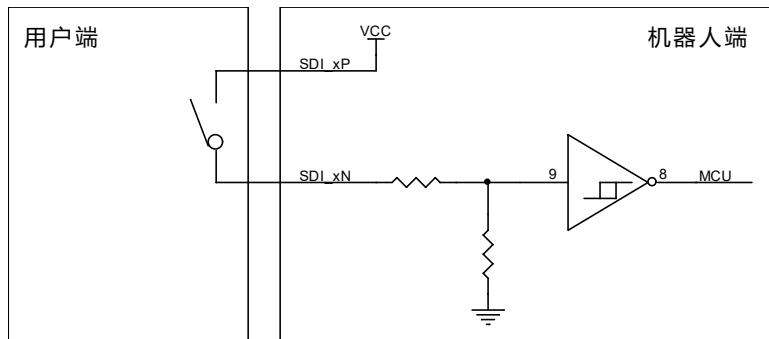
两个回路的电路原理相同，支持 24VDC 信号。
