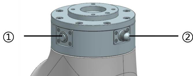
按住拖动示教按钮，可以使机器人进入拖动示教模式。
